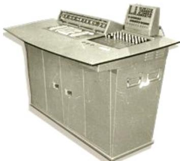
Машината “Проминь-2” изпълнява 32 операции, в това число чрез готови програми изчислява елементарни функции – тригонометрични, обратни тригонометрични, хиперболически, натурален логаритъм, експонента, корен втори. Машината може да обработва масиви и има готови функции за изчисляване на скаларно произведение на два вектора (не по-големи от 30-ти ранг) и за решаване на линейни алгебрични системи с не-повече от 7 неизвестни.
