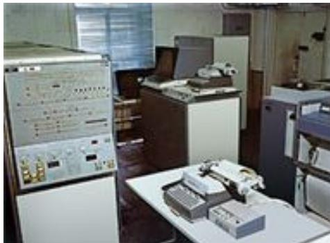
Моделът ЕС1022Б от единната система (ЕС) ЕИМ има 16 битова разрядна мрежа, система от 144 машинни команди, феритова памет с обем от 512[KB]. Машината се произвежда на базата на интегрални схеми с малка и средна степен на интеграция, позволяващи производителност от 80000 [op/s] по Гипсон. Притежава транслятори за Асемблер, Фортран, Кобол, ПЛ и работи под управление на ДОС-2.1. Това е най-масово произвеждания модел от единната серия машини. Произвежда се от 1975 до 1982 година.
